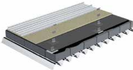
Kalzip FOAMGLAS ® System als Standard-Dachaufbau
