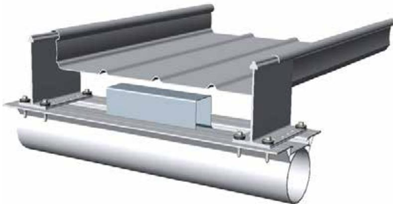
Abb. 4.10.2 Installation des LB Stützbleches zwischen zwei Klipps
