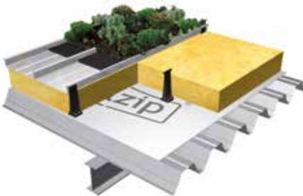
Auf allen vorher beschriebenen Dachaufbauten ist – bei Berücksichtigung der statischen Erfordernisse und bei Kalzip 65/333 – der zusätzliche Aufbau zum Kalzip NaturDach möglich.
