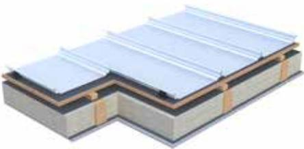
Dieses Profil kann auf den vorher beschriebenen Konstruktionen als kostengünstige Alternative verwendet werden. Aufgrund der geringen Materialdicke ist bei der Montage mit lastverteilenden Maßnahmen zu arbeiten. Standardmäßig werden gerade Kalzip Profile bis 20 m Bahnlänge eingesetzt.
