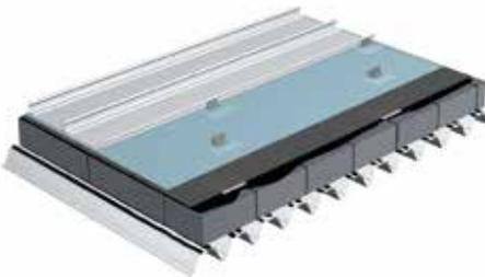
Kalzip AF ist auch auf FOAMGLAS®-Dämmung einsetzbar (siehe S. 20). Die Montage mit der Krallenplatte L verzichtet vollständig auf eine mechanische Verbindung zwischen den Kalzip Profilen und der Tragschale und ist somit wärmebrückenfrei. Die verwendeten Kalzip Verbundklipps erlauben eine optimale Gleitfähigkeit der Profile bei thermischer Längenänderung.
