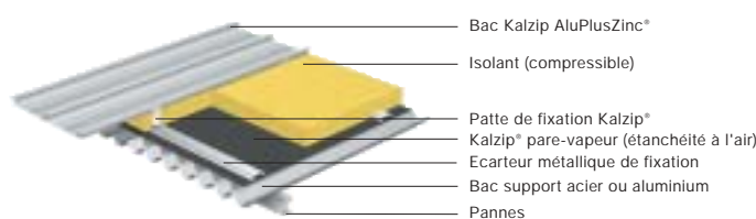
Toiture chaude Kalzip® - trame parallèle
