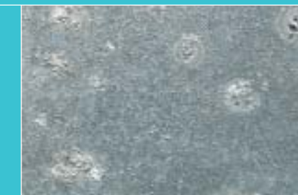
A gauche en haut : Complexe sportif d'athlétisme - Bayer Leverkusen (D) Arch. : D. Moors - Düsseldorf (D) A gauche : Zinc pré patiné (macrographie Test de Tenue à la Corrosion Corus - 250 jours) Au milieu : Kalzip AluPlusZinc®, procédé PEGAL® (macrographie - Test de Tenue à la Corrosion Corus - 250 jours)
